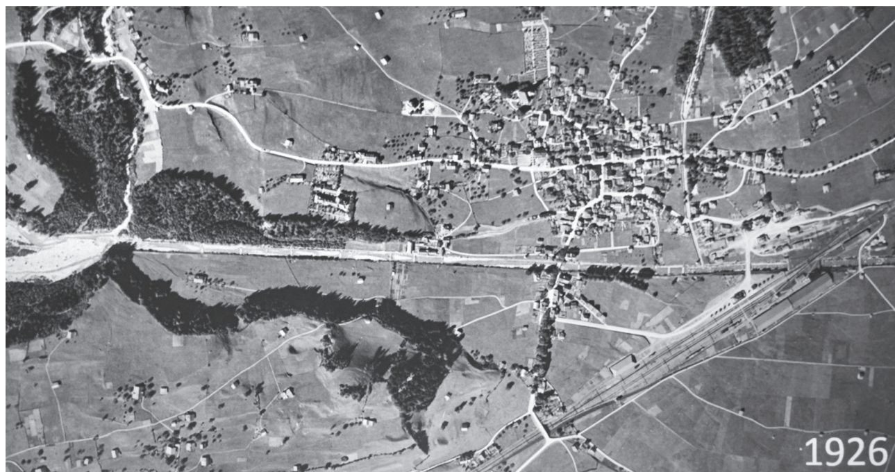
Hier zwei Ansichten der Engstlige von 1830 und 1926. Gut sieht man den Unterschied vor und nach der Kanalisierung des Flusses in den Jahren 1888 bis 1892. Diesem Verlauf folgt das Wasser noch heute.
